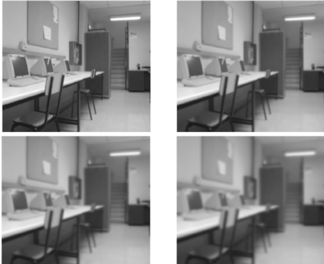
Figura 3: Observando las imágenes de izquierda a derecha y de arriba hacia abajo se presenta la aplicación de un filtro Gaussiano para valores \sigma=1 \sigma=2 \sigma=3 y \sigma=4 respectivamente.
