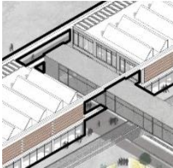
Figura 33: Vigas continuas en el patio interno
