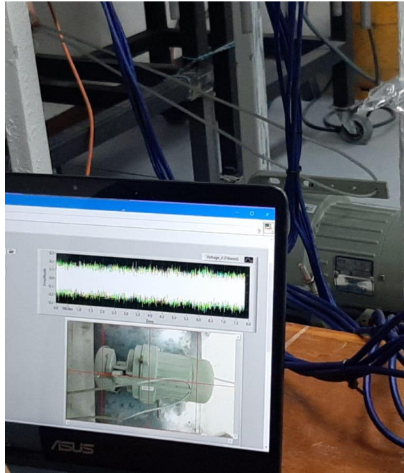
Figura 24 Procesamiento de datos del motor “sano” o nuevo
