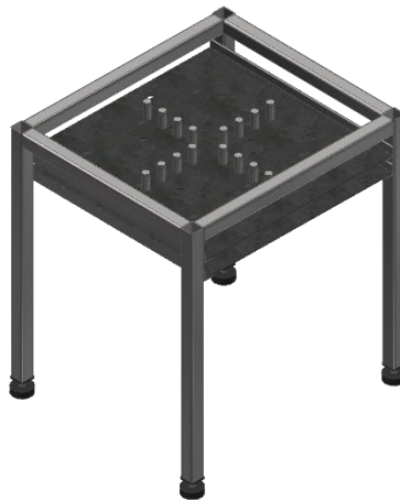
Figura 35 Modelo 3D de la cámara acústica y el arreglo cruz
