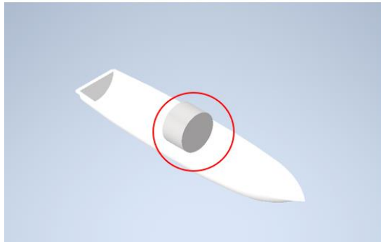
Figura 35: Asumiremos que el cilindro es la masa total de la basura que ejerce peso en la canoa
