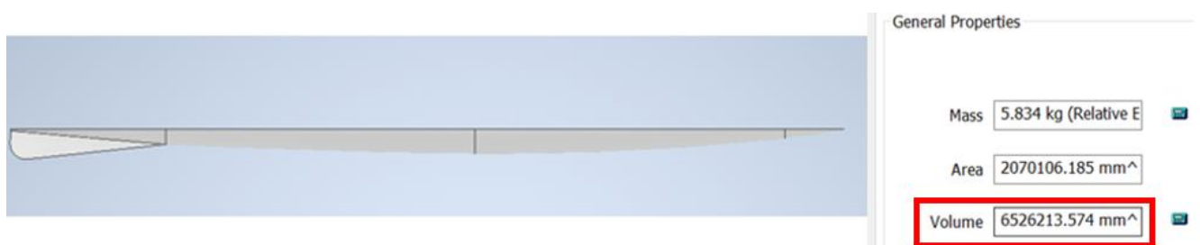
Figura 117: Volumen sumergido de la canoa.
