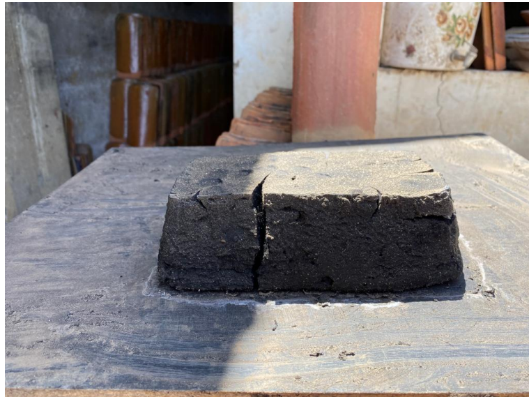
Figura 6. Espécimen 100% lodo partido en el proceso de secado
