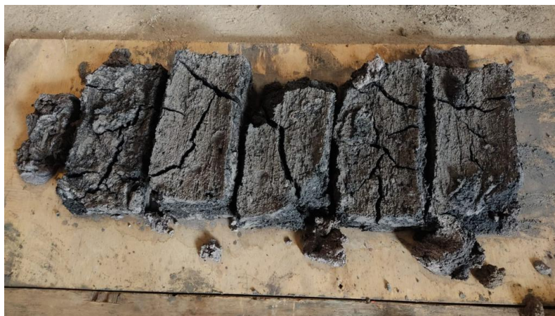
Figura 7. Especímenes de la mezcla de lodo, arena y cemento partidos en el proceso de secado
