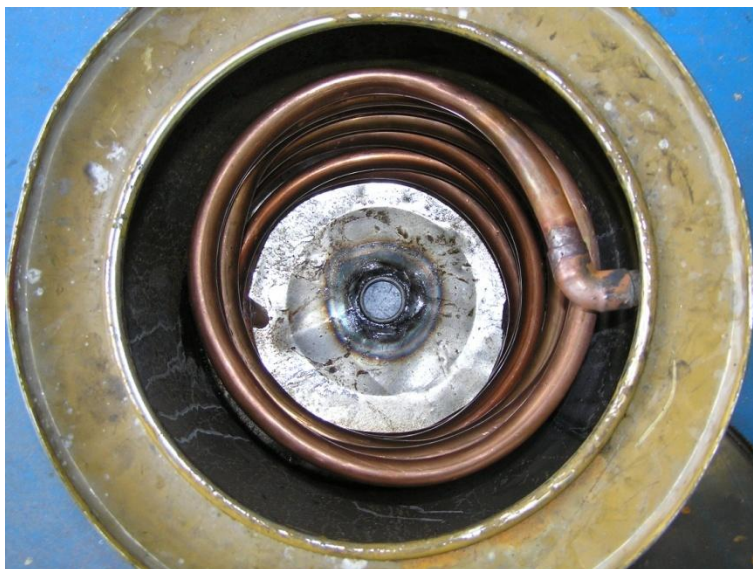
Figura 5.1: Serpentín dentro del tanque
