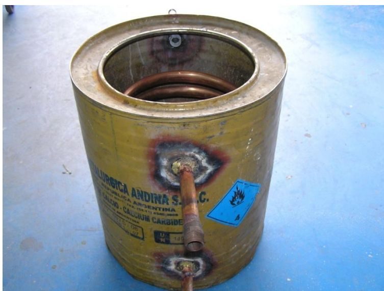
Figura 5.2: Acoples que salen del tanque y están soldados tanto al tanque como al serpentín
