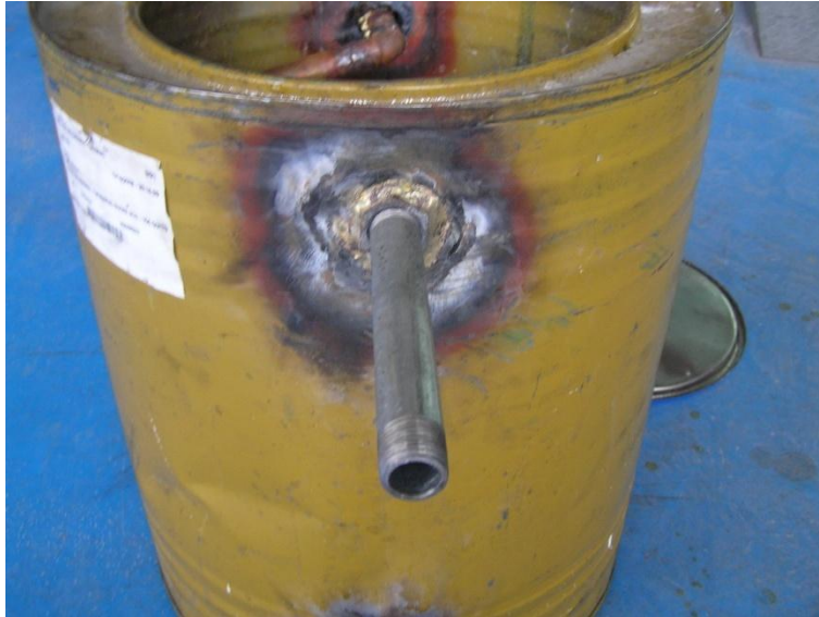
Figura 5.3: Busching superior para salida de agua unido a un acople de hierro galvanizado
