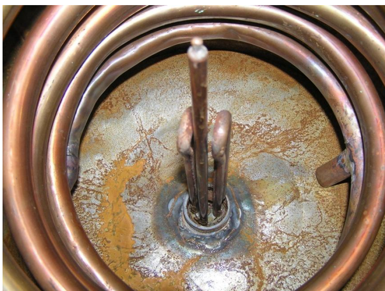
Figura 5.5: Resistencia conectada al intercambiador
