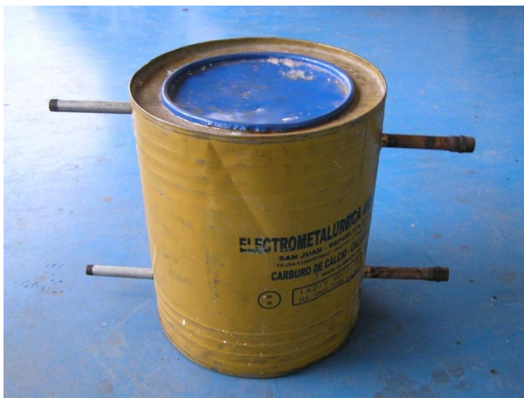
Figura 5.6: Intercambiador antes de ser pintado
