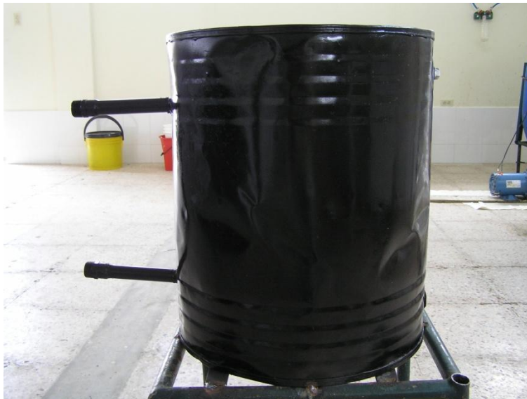
Figura 5.7: Intercambiador después de ser pintado
