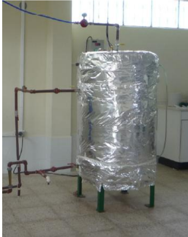
Figura 4.2: Biorreactor con aislamiento térmico
