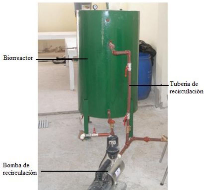
Figura 4.1: Biorreactor sin aislamiento térmico
