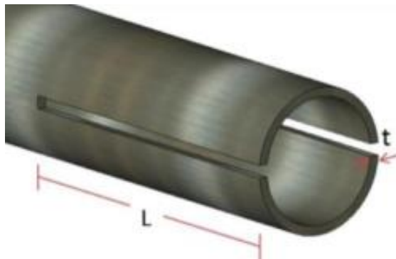
Figura 30. Dimensiones del extremo de la riostra a unirse con la cartela.
