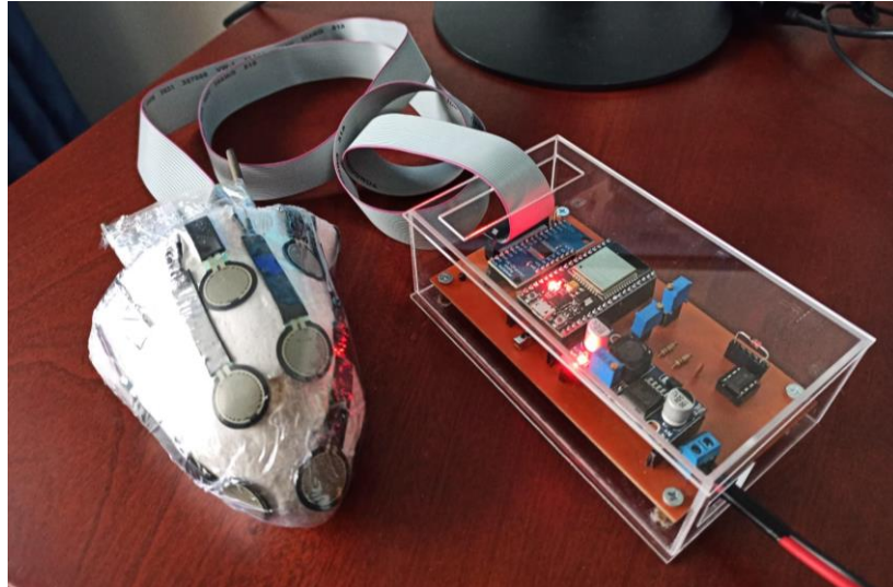
Figura 20.- Anexo: Placa terminada con sensores en muñón
