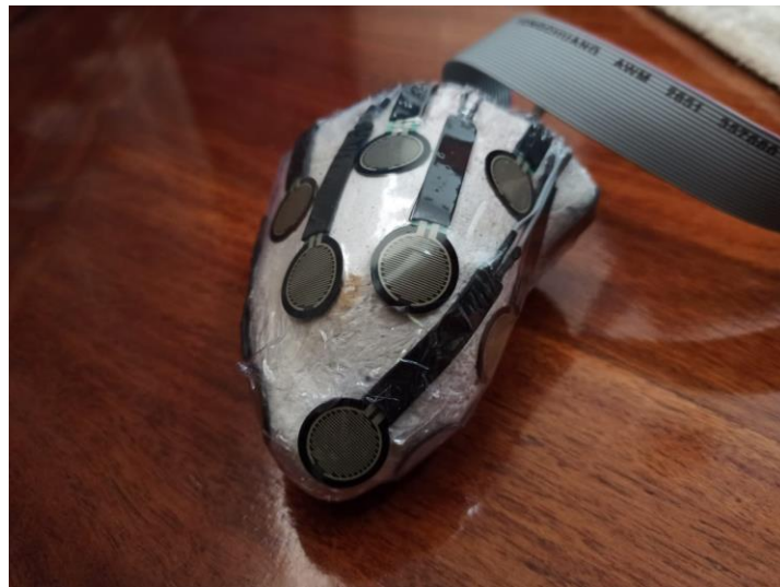
Figura 20.- Anexo: Placa terminada con sensores en muñón
