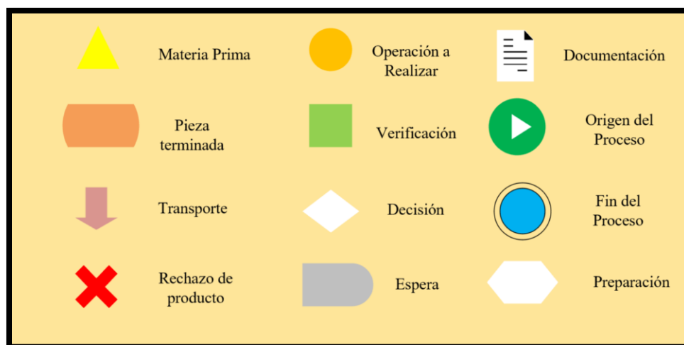
Figura 5. Simbología usada en los diagramas de procesos de fabricación.
