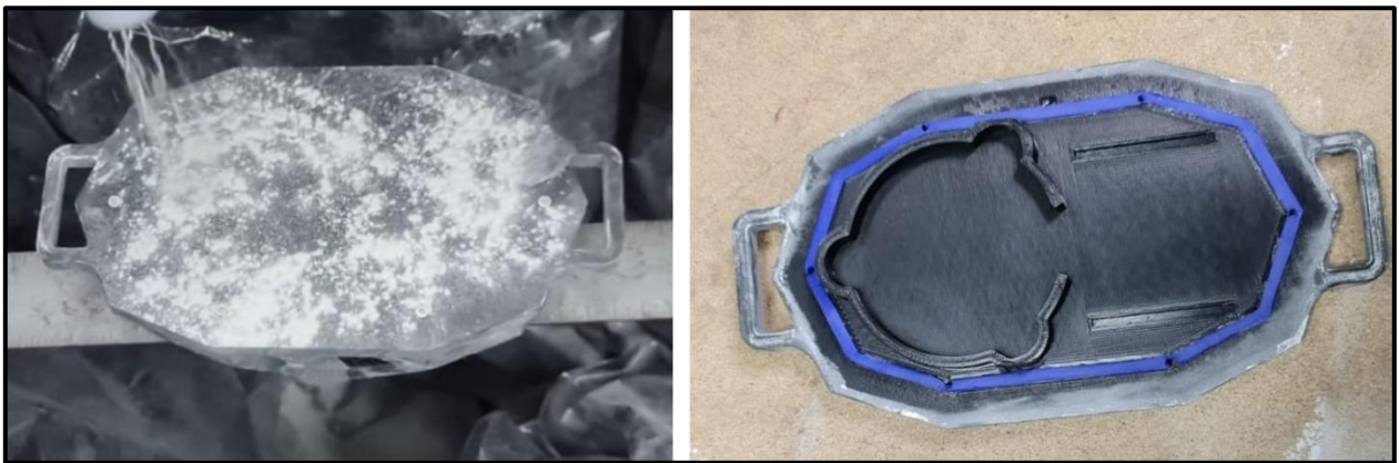
Figura 43: Ensayo de hermeticidad con talco cosmético.
