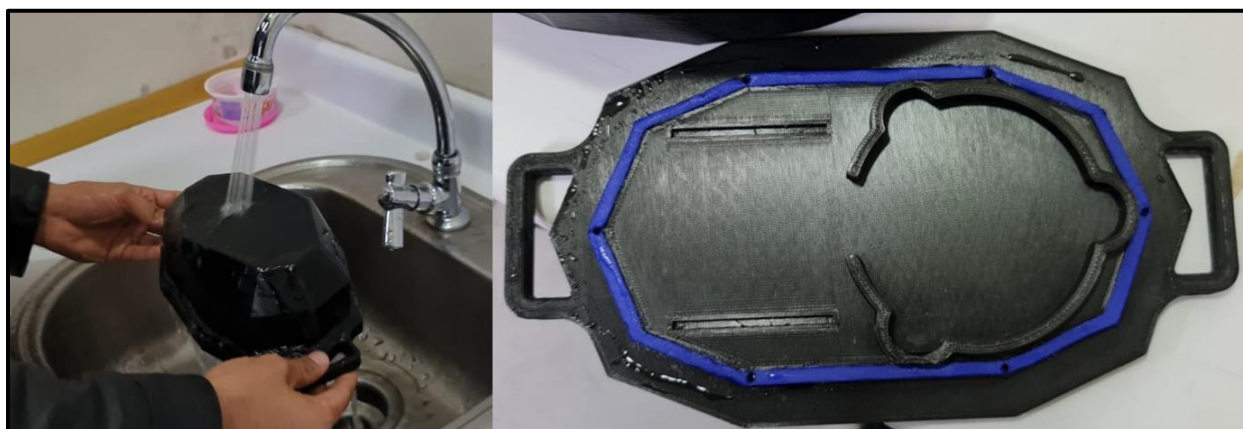
Figura 45: Ensayo de hermeticidad de líquidos, exposición a chorros en varias direcciones.
