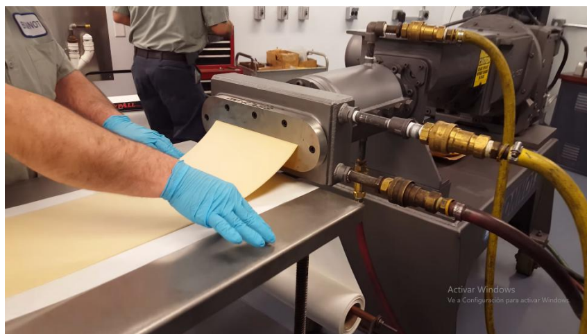
Figura A- 22. Extrusor disponible en el mercado que cumple con las especificaciones mínimas calculadas.
