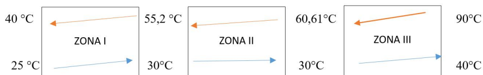
Figura A- 19. Diferencias de temperatura en cada zona del secador.
