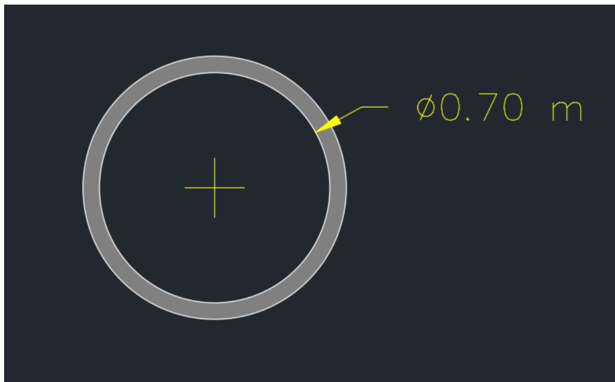
Ilustración 15. Dimensiones finales canal de conducción
