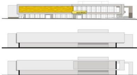
La forma del edificio deriva de la intersección de 4 volúmenes. Dos laterales que funcionan como sostén del volumen intermedio, en el cual genera un vacío. El volumen intermedio genera un vacío donde se revela la intersección del cuarto volumen donde se propone el andén.
