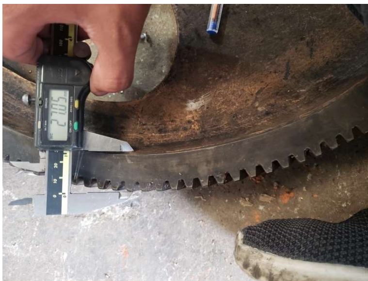
Figura 71 Toma del ancho y tamaño del diente del piñón mayor.
