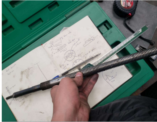
Figura 72 Notas de medidas tomadas para el tornillo sin fin del charriot.
