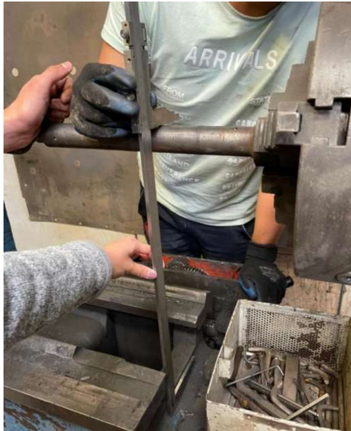
Figura 70 Toma de medida de la altura del eje del torno.
