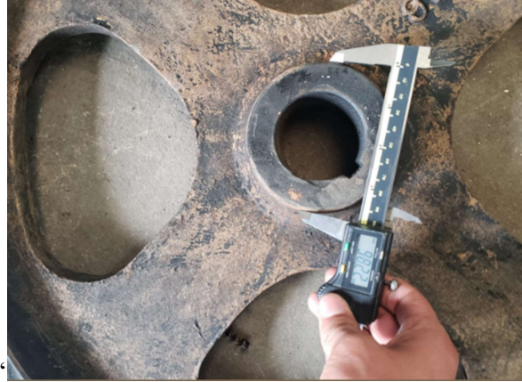
Figura 78 Toma de la medida para el diámetro externo del agujero del piñón mayor.
