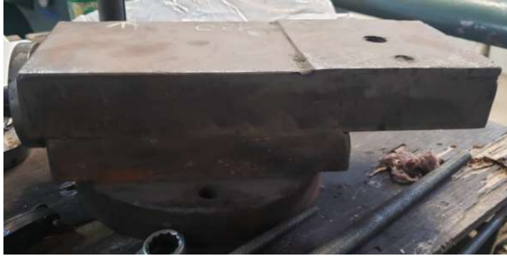
Figura 75 Charriot semi ensamblado.
