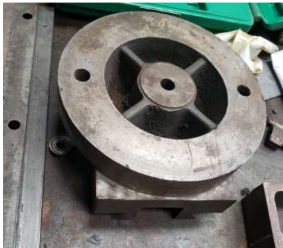
Figura 76 Disco inferior acoplable a charriot.
