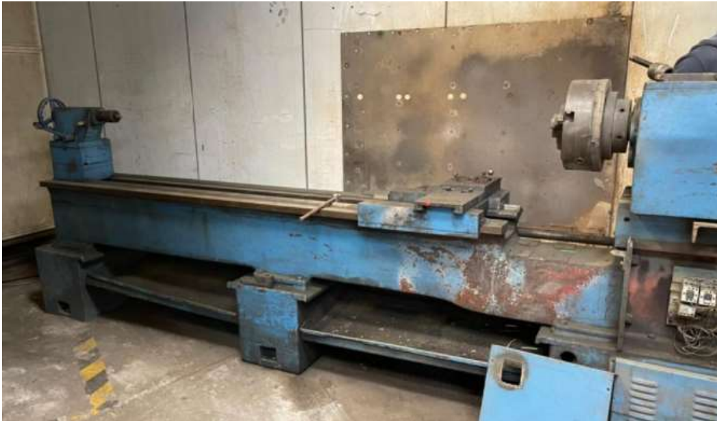
Figura 69 Torno IMETCA Cia. Ltda. en el que la rectificadora se adaptará.
