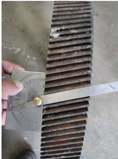
Figura 79 Medición del ángulo de los dientes helicoidales del piñón mayor.
