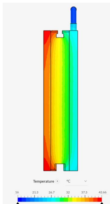
Figura 69: Distribución de temperatura después de simulación, configuración en serie. Vista lateral. Temperatura de controlador superior a 40 [°C]; se marca de color rojo la sección más caliente.
