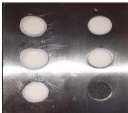
**Figura 15.** *Placa metálica con resina acrílica ALIKE GC.*
