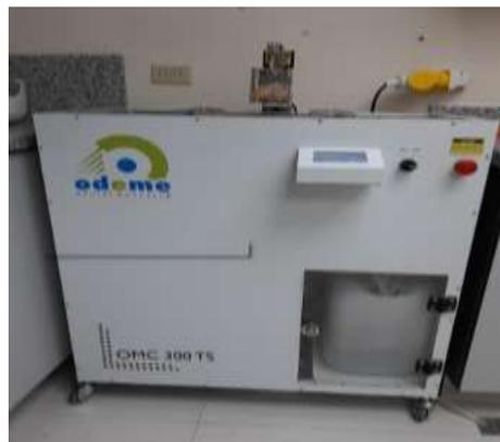
Figura 28. Máquina de termociclado.
