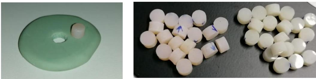
**Figura 7** Molde de Silicona de Condensación para la fabricación de discos de resina. Los especímenes fueron curados con la unidad de fotopolimerización (Elipar 3M ESPE), durante 20seg a través de la tira de Mylar. Después de cada cinco muestras, la salida de luz se verificó utilizando un comprobador fotométrico (Radiometer / ayDentek, Inc., Buffalo, NY, EE. UU.) Que excedió los 400 mW / cm.
