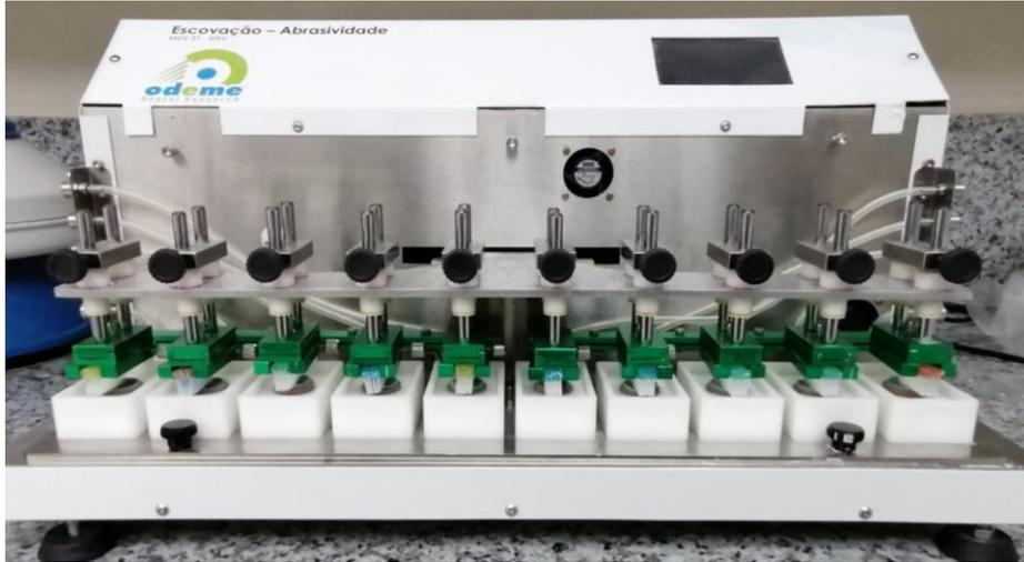
**Figura 14** Máquina de simulación de cepillado (Odeme, SP-Brasil)
