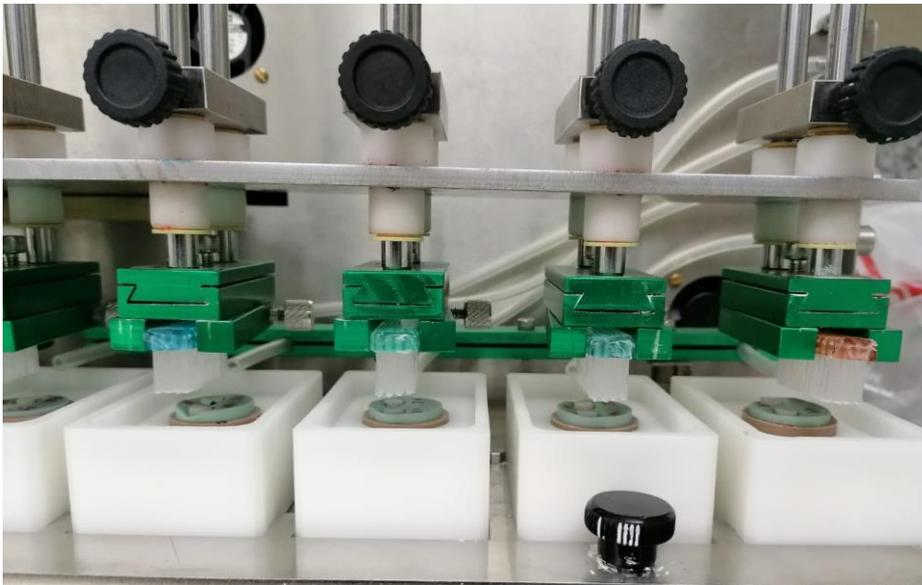
**Figura 15** Ubicación de las muestras y los cepillos en la máquina de simulación de cepillado.
