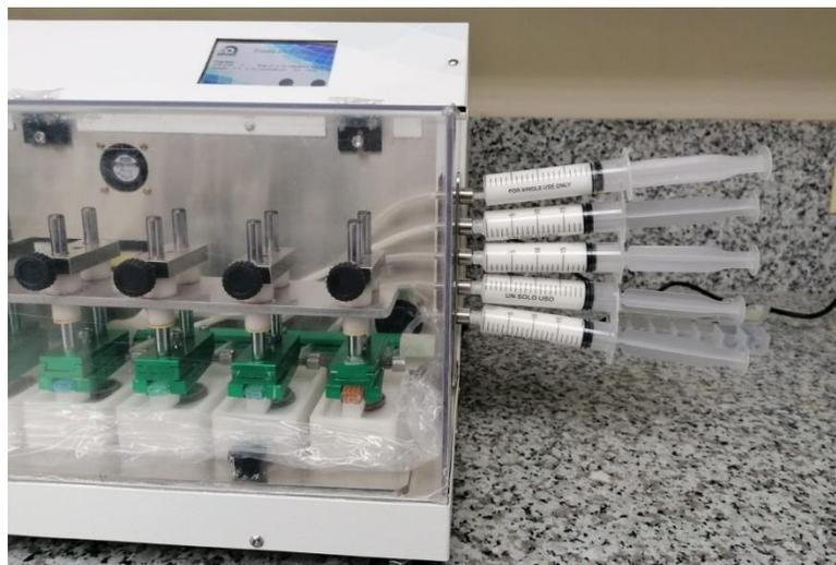
**Figura 17** Ubicación en la máquina de jeringuillas con el dentífrico diluido
