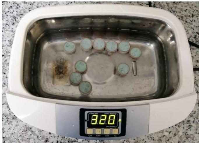
**Figura 12** Colocación de las muestras en cuba ultrasónica después del pulido.
