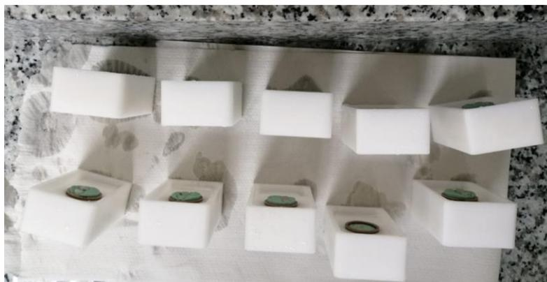
**Figura 19** Secado de las muestras al ambiente por 24 horas posterior al cepillado
