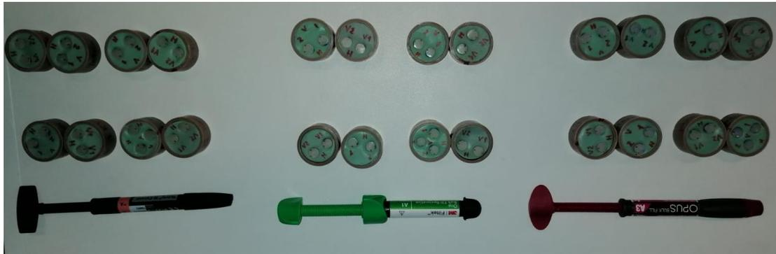
**Figura 9** Muestras colocadas en tubos de PVC embutidos con silicona pesada.
