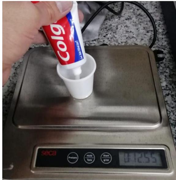
**Figura 16** Dilución del dentífrico con agua en proporción de 1:1
