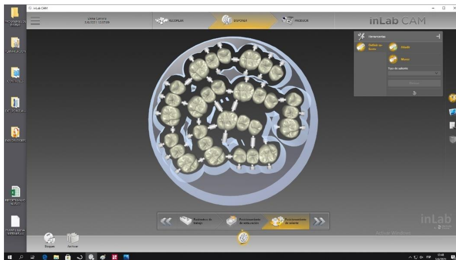
Ilustración 17 Colocación de las restauraciones dentro del disco a ser fresado
