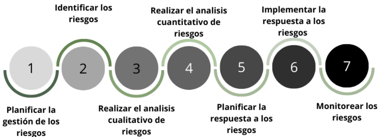
Ilustración 97: Gestión de riesgos Fuente: Guía del PMBOK Sexta edición (2021) Elaboración: Alvaro Berrazueta
