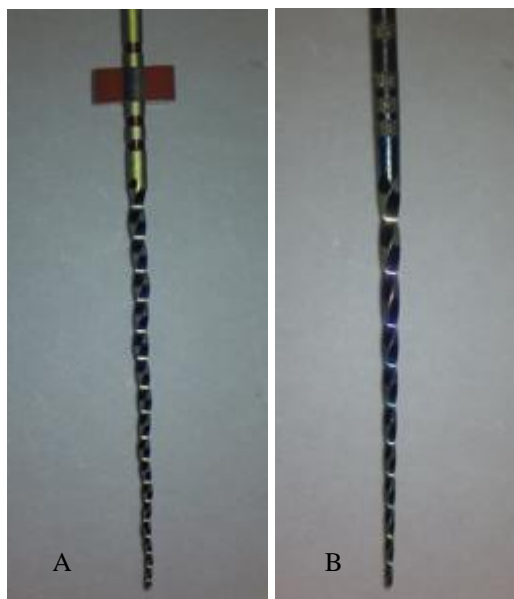
Imagen 23 Fotografías de instrumentos obtenidas con microscopio dental para descartar presencia de defectos superficiales. A. Trunatomy. B. Hyflex CM.
