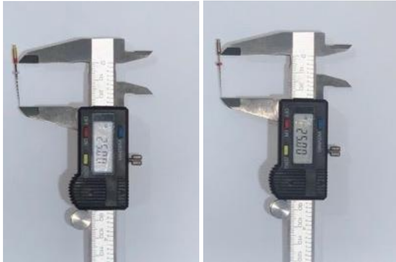
Imagen 24 Medición longitud de instrumentos con calibrador digital
