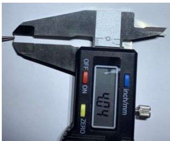
Imagen 38 Medición longitud de fragmentos con calibrador digital
