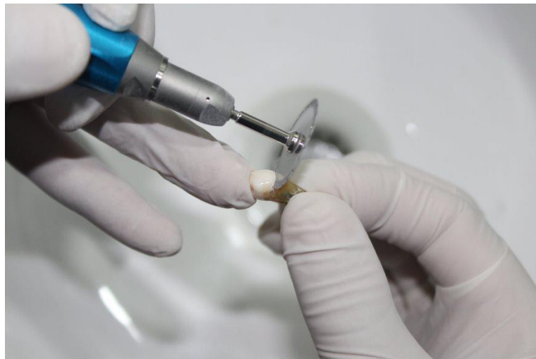
Figura 4 Seccionamiento de la corona de la muestra
