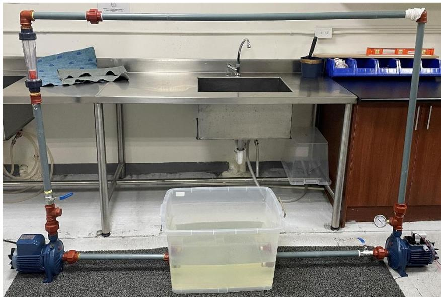
Figura 11: Sistema Hidráulico. Laboratorio de Ing. Hidráulica USFQ.
