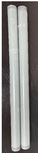
*Figura 35: Tubería PVC de 1 in de diámetro. Laboratorio de Ing. Hidráulica USFQ.*
