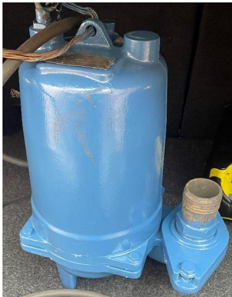
*Figura 49: Bomba Marca "Goulds Pumps" Sumergible de 2 HP. Laboratorio de Ing. Hidráulica USFQ.*
