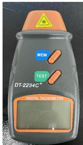
*Figura 44: Tacómetro Digital. Laboratorio de Ing. Hidráulica USFQ.*
