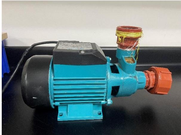
*Figura 48: Bomba Marca "Paolo" de 1/2 HP. Laboratorio de Ing. Hidráulica USFQ.*
