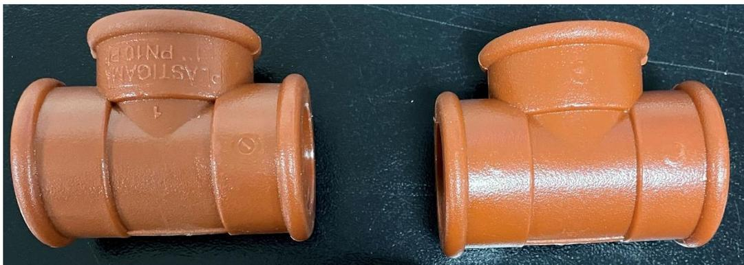
*Figura 38: Acople Tubería PVC "Tee" de 1in de diámetro. Laboratorio de Ing. Hidráulica USFQ.*
