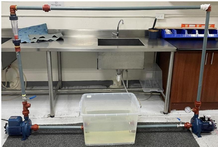
Figura 52: Sistema Hidráulico Prueba N° 1. Laboratorio de Ing. Hidráulica USFQ.
