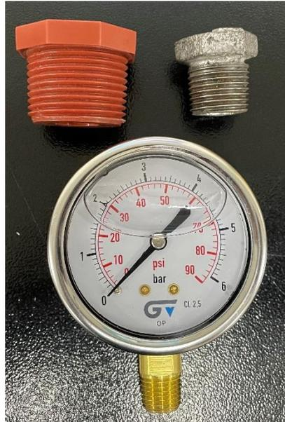
*Figura 41: Manómetro, Reducción Bushing PVC Roscable y de Acero Galvanizado de 1/2 in de diámetro. Laboratorio de Ing. Hidráulica USFQ.*
