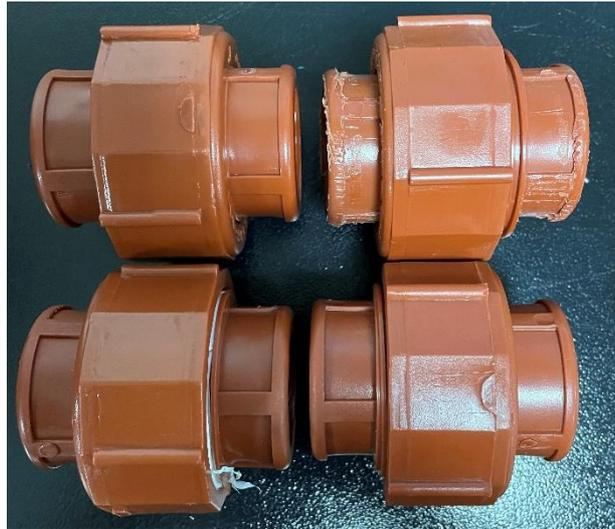
*Figura 36: Uniones Roscables Universales de 1in de diámetro. Laboratorio de Ing. Hidráulica USFQ.*
