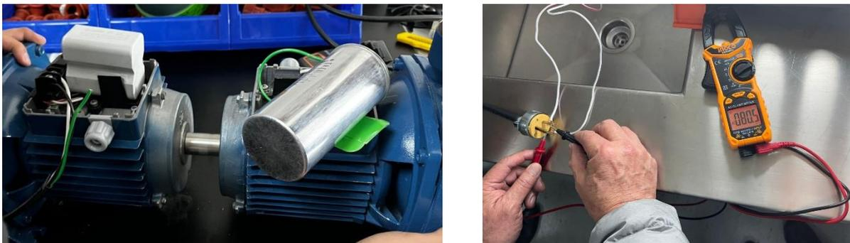
*Figura 18: Generación de 80.50 V con Capacitor Electrolítico de 80  $\mu$ f. Elaboración Propia.*
