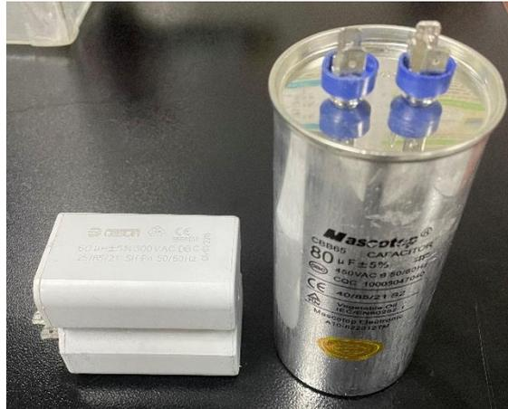
*Figura 45: Condensador de Papel de 60  $\mu$ f (izquierda) y Condensador Electrolítico de 80  $\mu$ f (derecha). Laboratorio de Ing. Hidráulica USFQ.*
