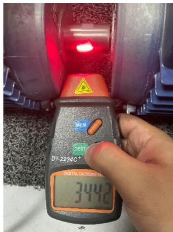
*Figura 17: Comprobación de Velocidad Angular Mecánicamente. Elaboración Propia.*
