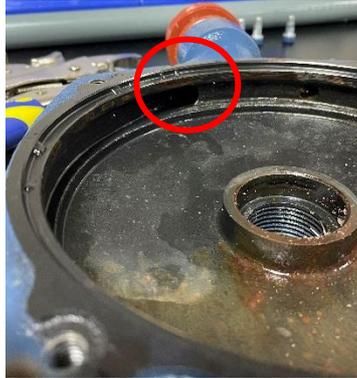
*Figura 25: Brida de Impulsión Interna de la Bomba. Laboratorio Ing. Hidráulica USFQ.*
