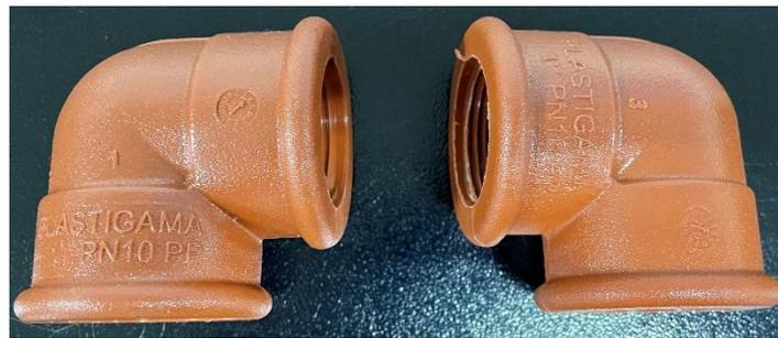
*Figura 37: Codos Tubería PVC de 1in de diámetro. Laboratorio de Ing. Hidráulica USFQ.*
