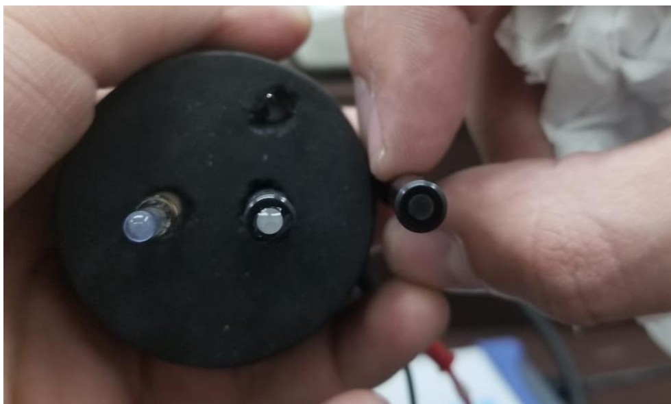
Figura 14. Electrodo de carbono vidriado con film de mercurio (izq.) y sin film de mercurio (der.)
