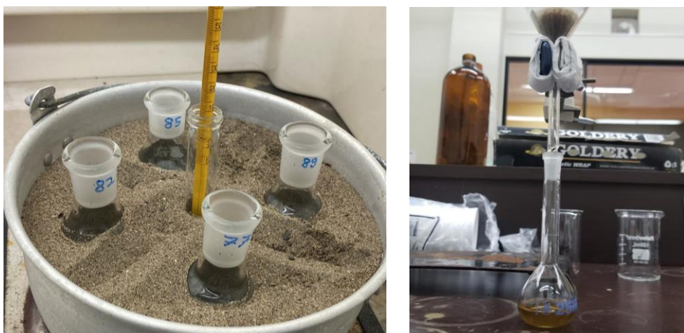
Figura 17. Sistema de baño de arena para digestión ácida de leches (izquierda) y filtración de solución tras digestión (derecha).
