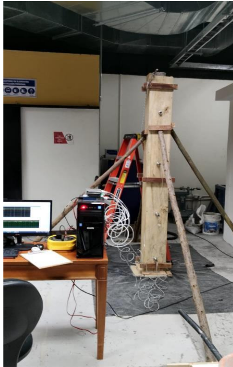
Figura 21. Colocación de Columna en Laboratorio de la USFQ.
