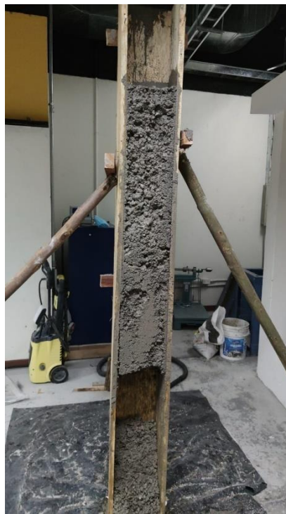
Figura 22. Obstrucción del Agregado Grueso en los Sensores.
