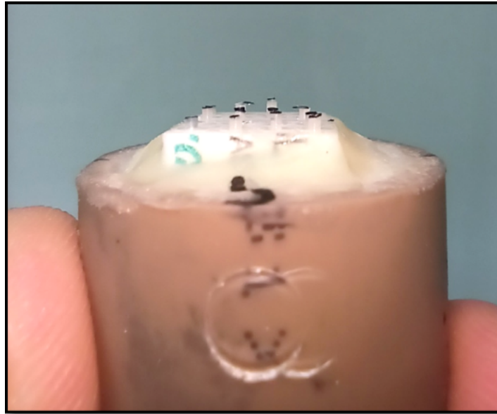
Fig. 5 Pilares de cemento, después de remover los tubos Tygon
