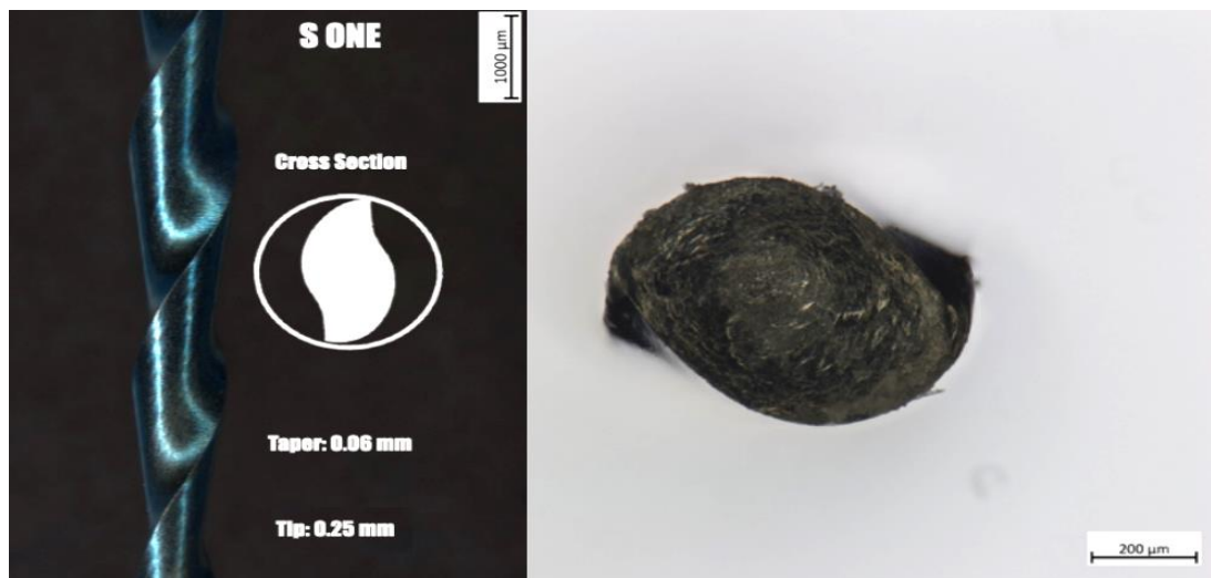
Ilustración 10: Sección transversal Fanta S-One 25.06
