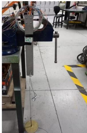
Figura 48. Sensor posicionado para carga de fuerza “Y”
