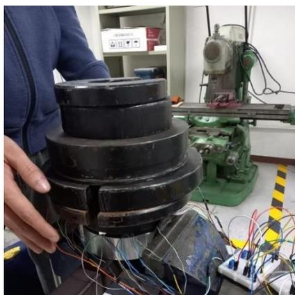
Figura 46. Sensor posicionado para carga de fuerza “Z”
