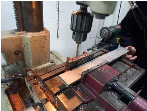
Figura 43. Perforación de agujeros en platina para carga de momentos sobre el sensor
