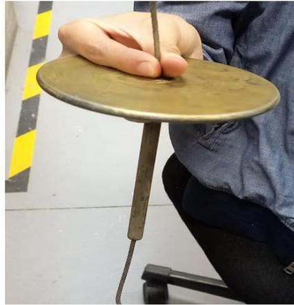
Figura 44. Sistema de plato de disco y cuerda de tensión
