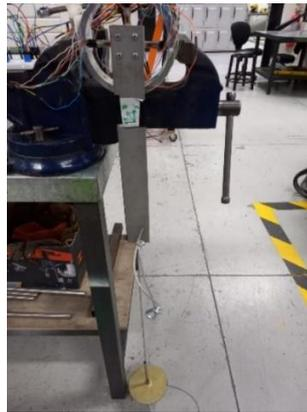
Figura 47. Sensor posicionado para carga de fuerza “X”
