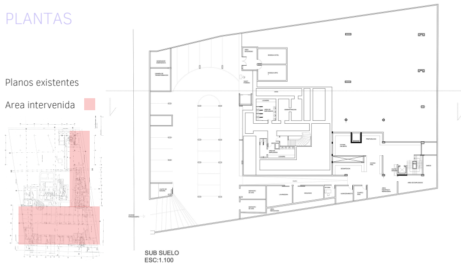
Figura 14 Planta Sub Suelo
