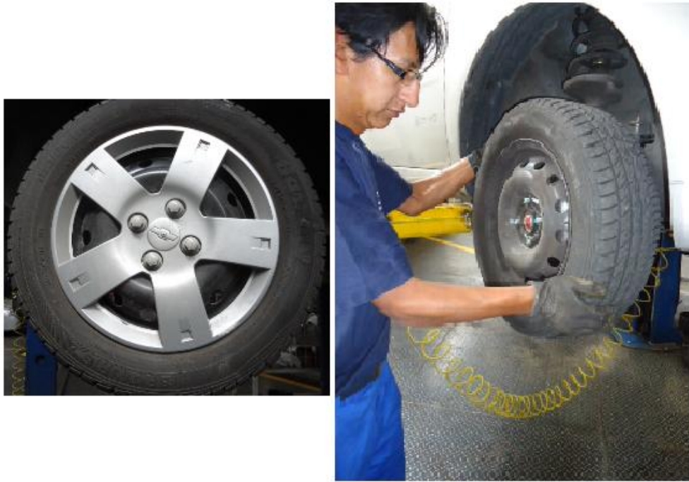
Figura 4-17 Ejemplo de rueda del grupo 1 y la forma de agarre que el diseño de la misma provoca.
