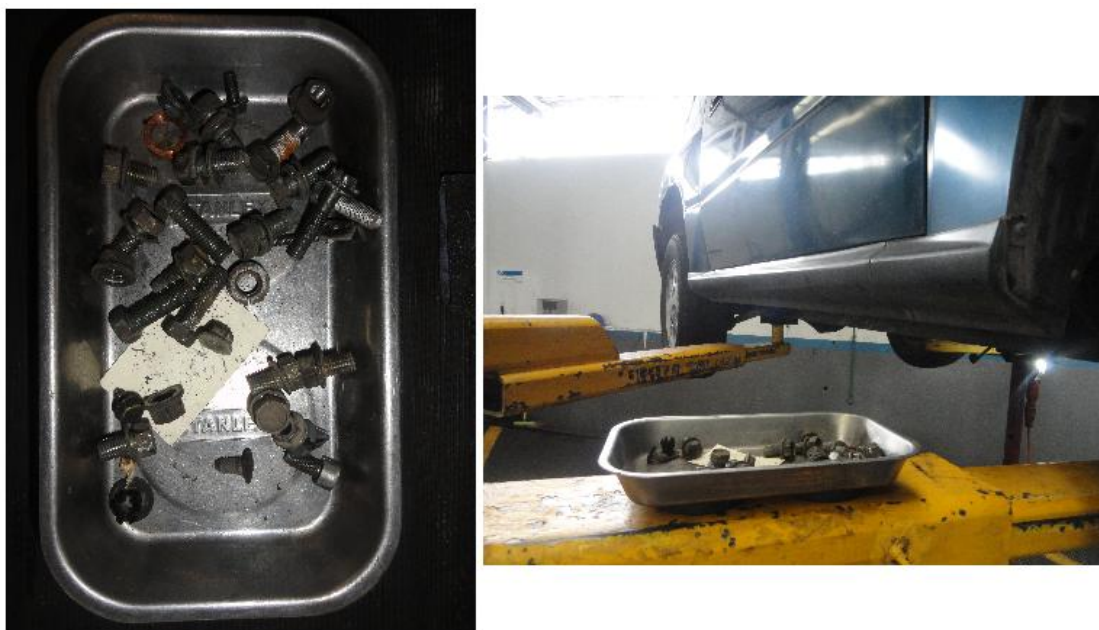
Figura 4-5 Bandejas magnetizadas ubicadas en las patas del elevador de tijeras para colocar los pernos de las ruedas.
