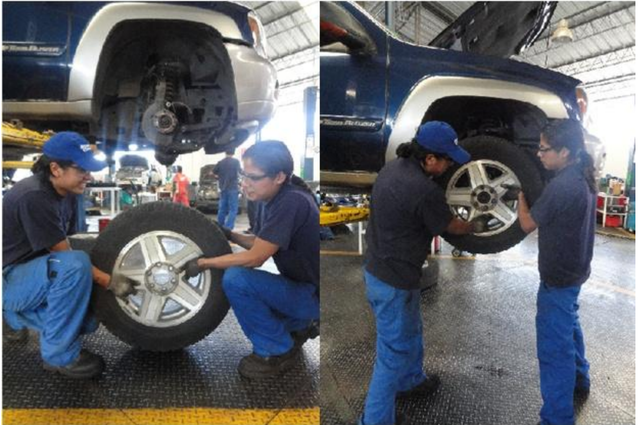
Figura 4-22 Montaje de rueda de un vehículo del grupo 2 entre 2 técnicos.
