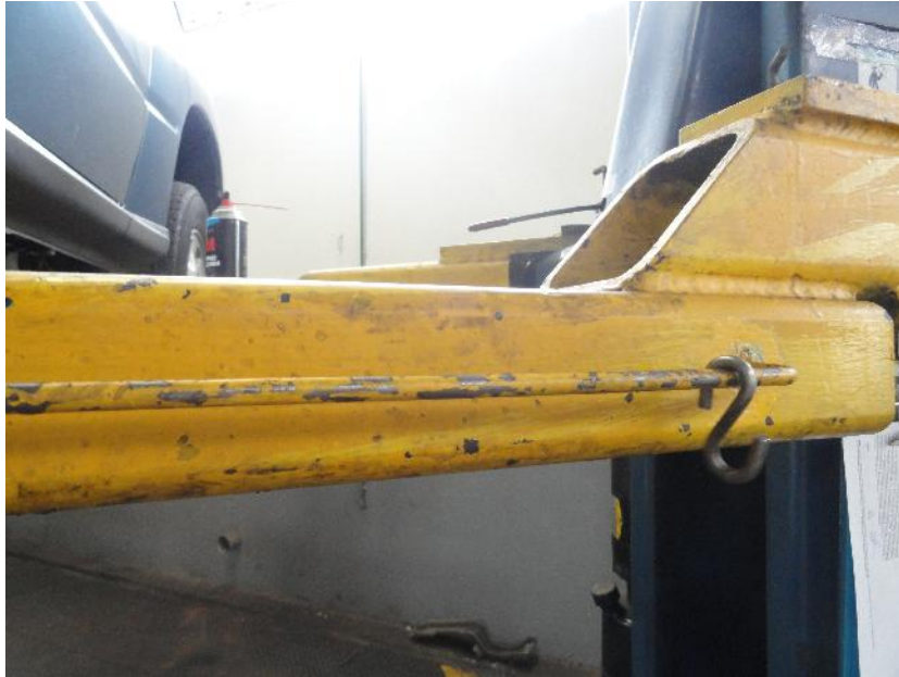
Figura 4-9 Ganchos ubicados en las patas del elevador de tijeras para colgar las pistolas neumáticas.
