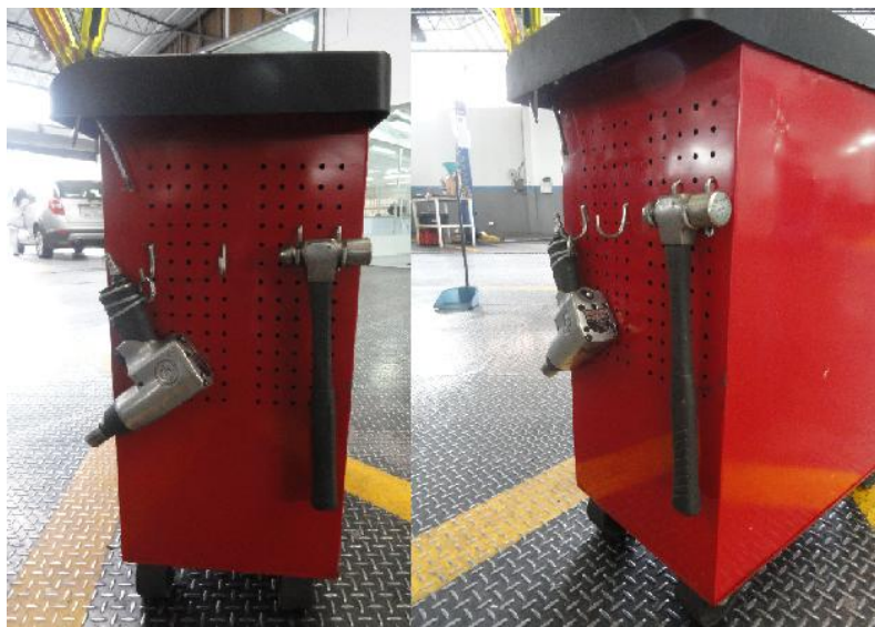
Figura 4-3 Ganchos extraíbles para colgar herramientas ubicados en la pared lateral de la caja de herramientas.
