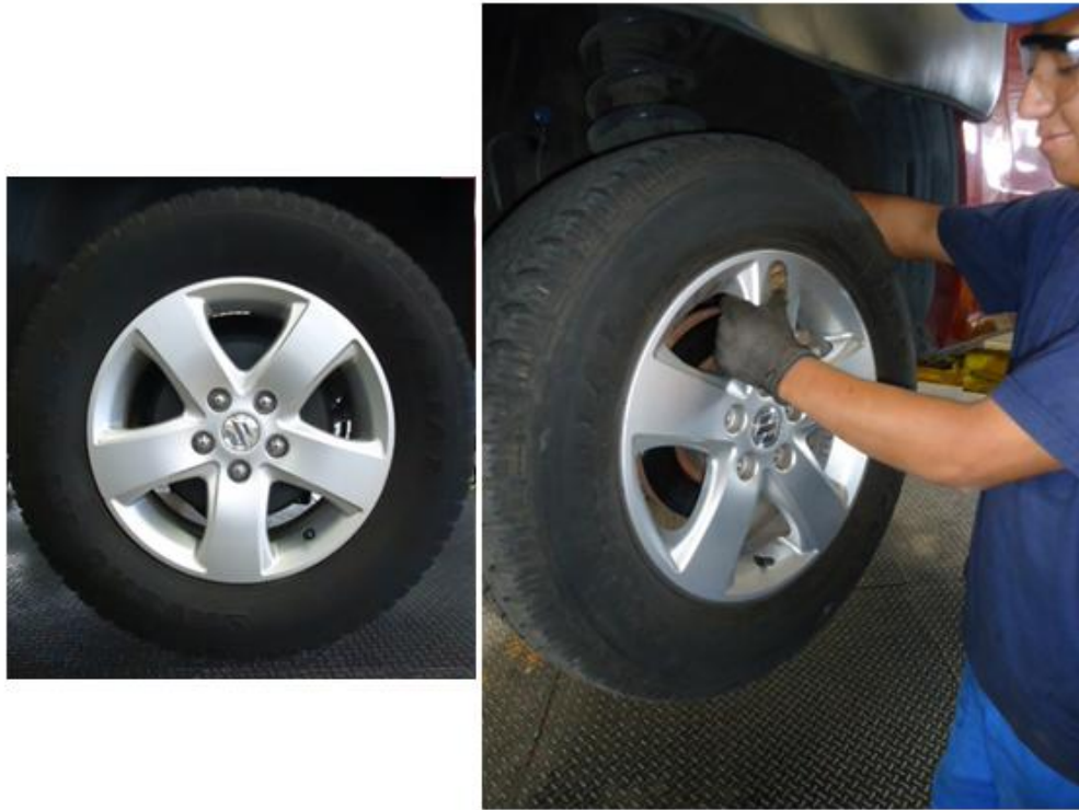
Figura 4-18 Ejemplo de rueda del grupo 2 y la forma de agarre que el diseño de la misma provoca.
