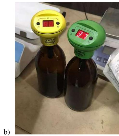
*Figura 24. Determinación DBO5 con el equipo OxiTop*
