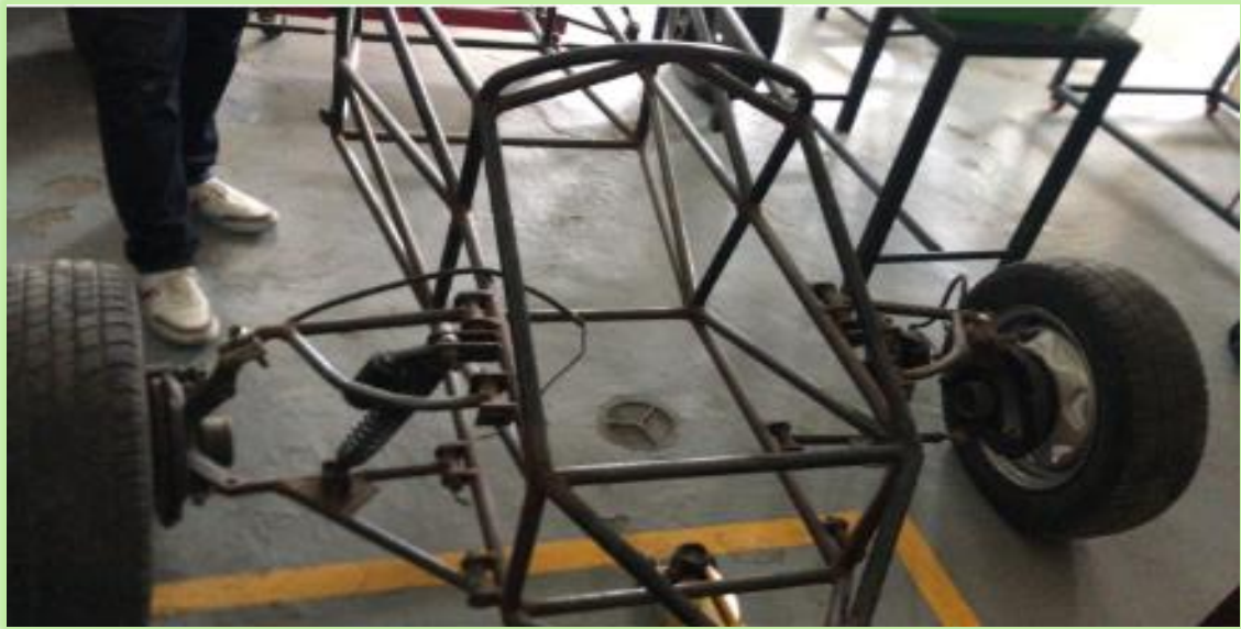
Figura 13. Sección del chasis designada para el sistema de dirección del vehículo (USFQ, 2022)
