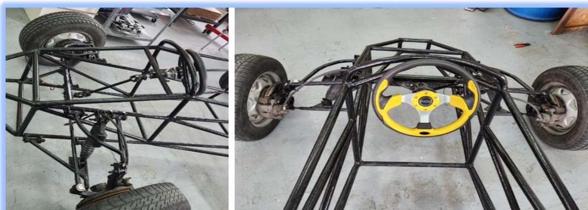
Figura 53. Prueba de holguras en el sistema – Inspección de los elementos (USFQ, 2022)
