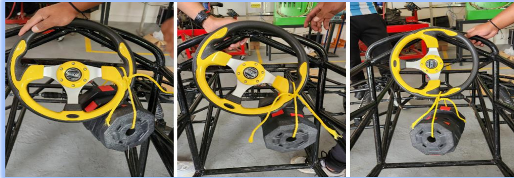
Figura 47. Prueba de maniobrabilidad – Fuerza mínima requerida para girar el volante (USFQ, 2022)
