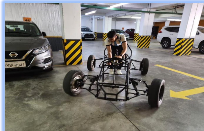
Figura 45. Prueba de maniobrabilidad – Avance con giro a la derecha (USFQ, 2022)
