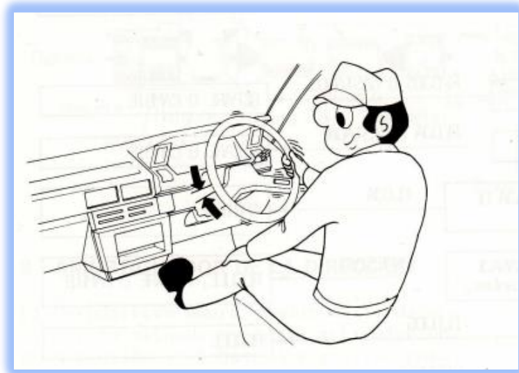
Figura 62. Procedimiento para la comprobación del juego libre del volante (TOYOTA, 2014)
