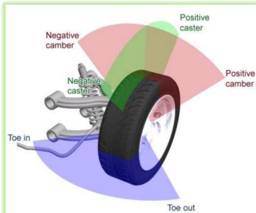
Figura 70. Cotas – Geometría de Dirección (Gómez, 2020)
