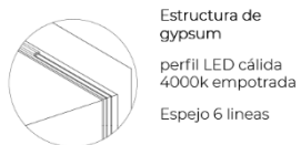
DETALLE INSTALACIÓN DE LUZ
