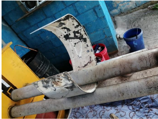
Figura 37 Rolado de la bóveda
