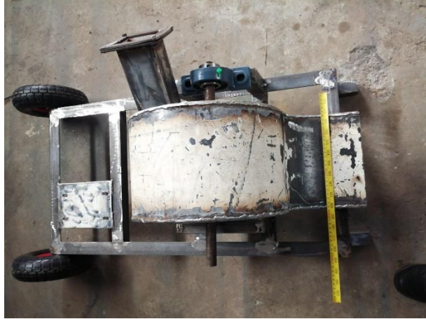
Figura 39 Soldadura y ensamble
