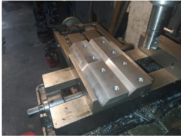
Figura 40 Perfilar y cortar las cuchillas
