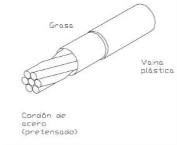
Figura 20. Detalle pretensado de acero
