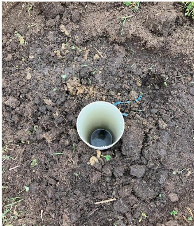
*Figura 16: Ensayo de permeabilidad in-situ [Proaño J.S. 2022].*
