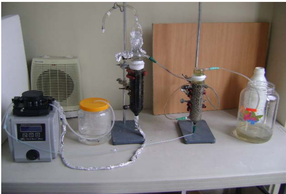
Figura 2.4 Fotografía del sistema de tratamiento biológico-físico-químico (BFQ) de los drenajes ácidos de mina. El bioreactor de flujo ascendente fue alimentado con una muestra sintética compuesta por acetato ( 2.5 \text{ g DQO L}^{-1} ), sulfato ( 3000 \text{ mg L}^{-1} ) y el medio basal, y empacado con 15 \text{ g SVS L}^{-1} de los sedimentos de la laguna artificial de la USFQ soportados en arena en un modo de operación continuo. El reactor físico-químico de flujo ascendente fue empacado con arena y alimentado simultáneamente por el puerto lateral inferior con el sulfuro biogénico generado en el bioreactor en una concentración de 130 \text{ mg L}^{-1} aproximadamente y por el puerto que está en la base con DAM sintético con 30 \text{ mg L}^{-1} de cobre (II) y pH 2.7. (Fotografía tomada por Lorena Gallardo).
