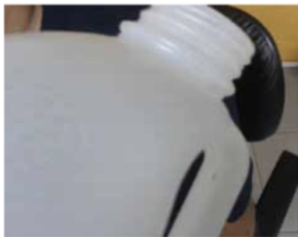
Orificios por Manga Incompleta
