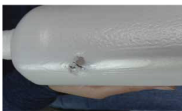
Imperfecciones por Mal llenado de Molde
