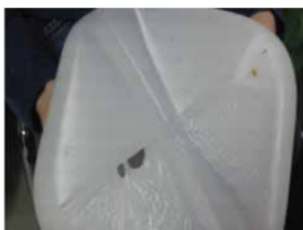
Orificios por Manga Incompleta
