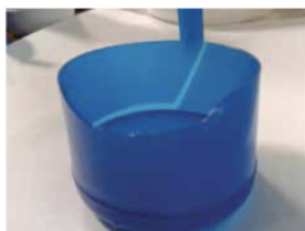
Imperfecciones por Mal llenado de Molde
