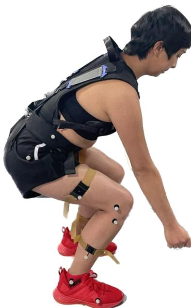
*Imagen 3. Demostración de la activación del sistema de bandas elásticas del Liftsuit al realizar una sentadilla.*
