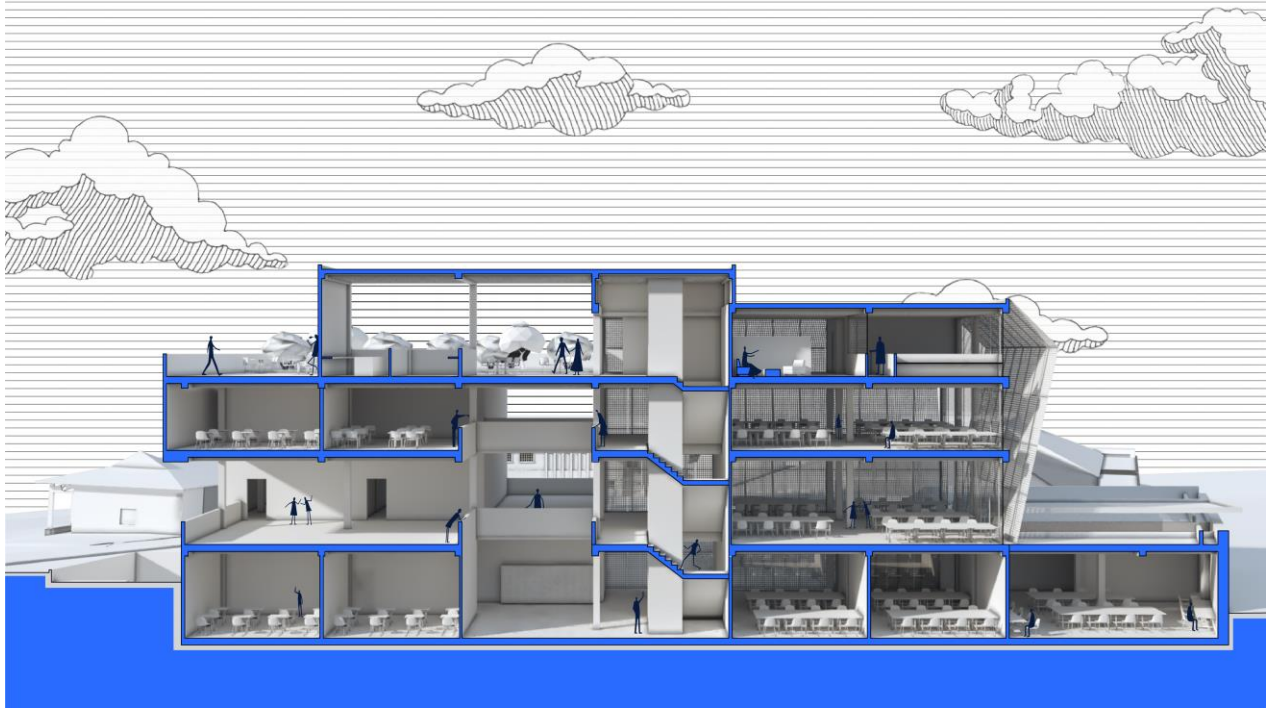
Figura 27. Corte Longitudinal. Ilustración del autor.
