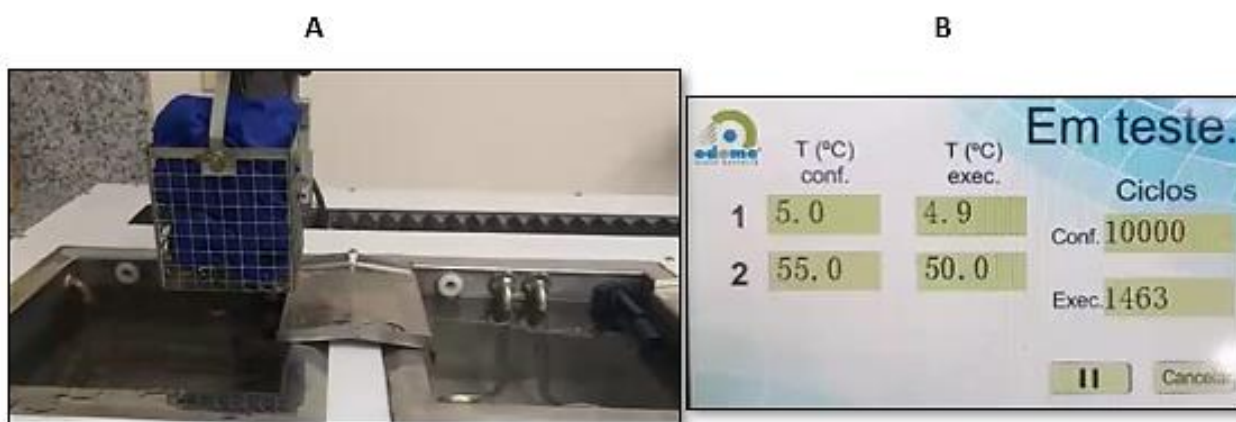
Figura 10. A: Máquina termocicladora ubicado en el laboratorio de investigación de la Escuela de Odontología de la USFQ. B: Muestras sometidas a 20.000 ciclos, lo que representa a dos años de envejecimiento, las muestras fueron sometidas a 10.000 ciclos en dos etapas
