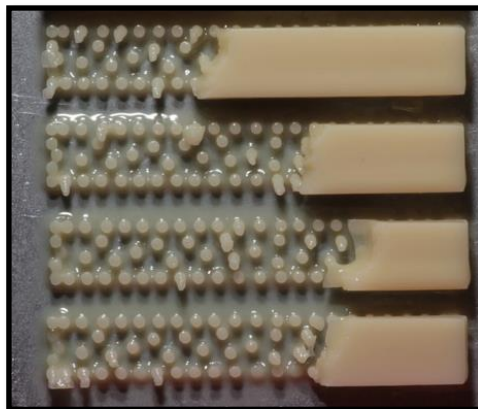
Figura 6. Muestras defectuosas impresas en 3D.
