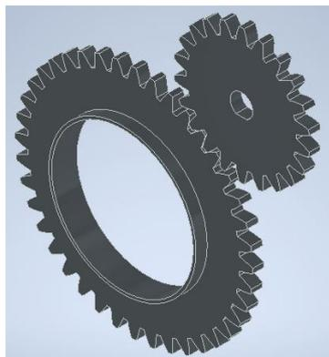
*Figura 33. Sistema de engranajes*
