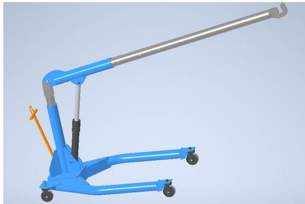
Figura 2. Modelo CAD de grúa móvil
