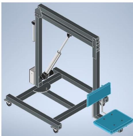
*Figura 4. Grúa construida como prototipo inicial*
