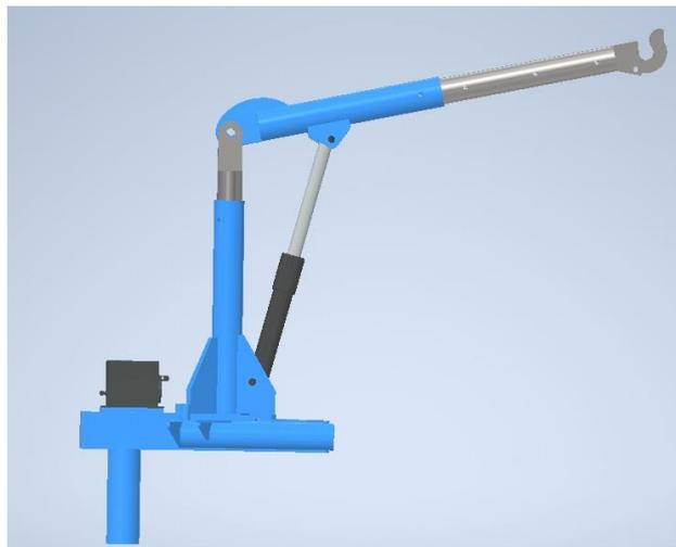
Figura 3. Modelo CAD de grúa fija
