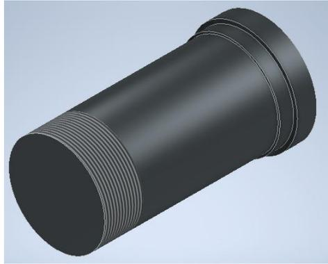
*Figura 38. Eje de giro a fatiga*
