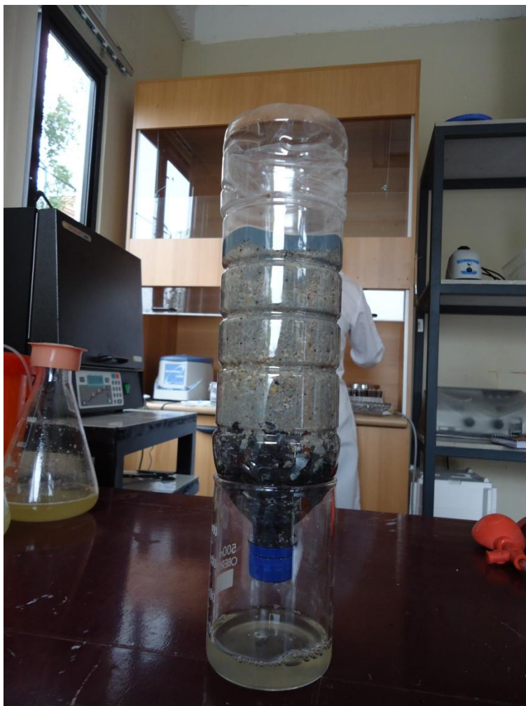
Foto 20: Incorporación del filtro de arena para tratamiento de la mezcla obtenida del reactor de neutralización.
