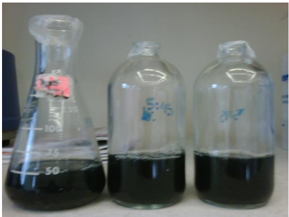
Foto N°7: Mezcla pelambre curtido relación de volumen 10/90%
