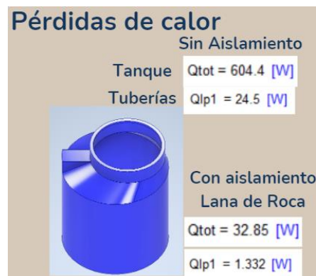
Figura 8 Pérdida de calor en tanque con y sin aislamiento térmico.
