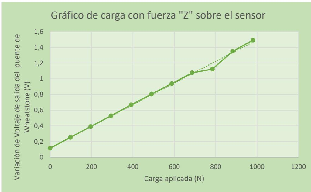
Figura 35 Diferencial de voltaje vs Carga aplicada para Fuerza Z
