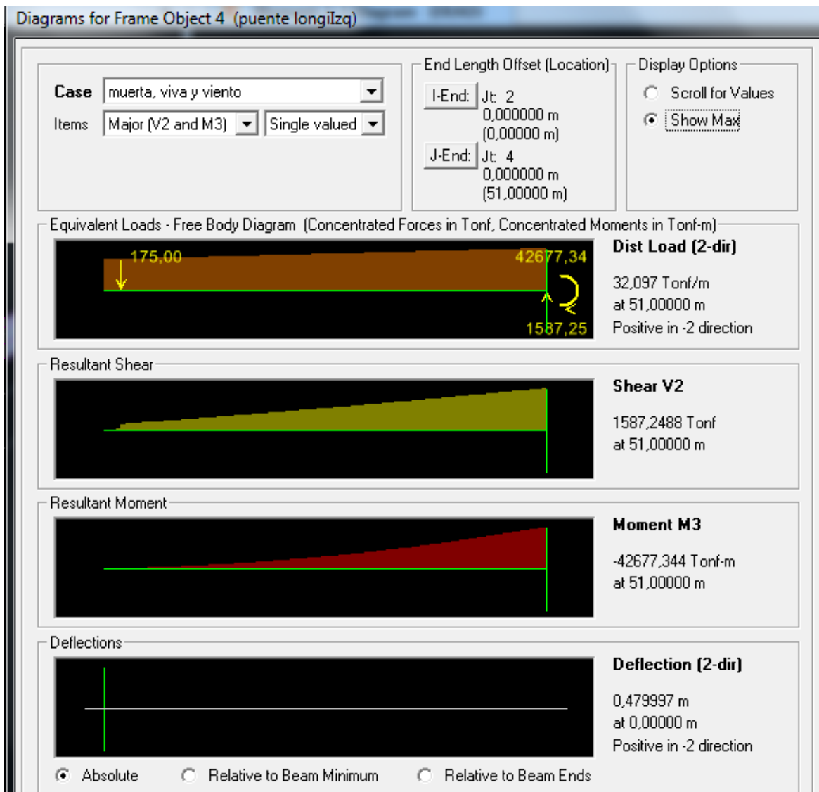
Figura 5.6.10. Resultados del estado de cargas crítico durante la etapa de construcción sin considerar las cargas de pretensión superior ni inferior.
