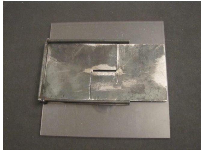
Figura 4. Colocación del molde metálico
