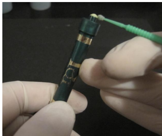
Figura 8. Retiro de una cantidad de adhesivo PQ1 con aplicador.
