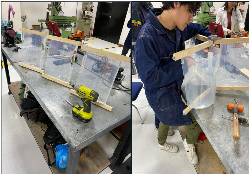
Figura 75 Construcción de la turbina del generador eólico de eje vertical
