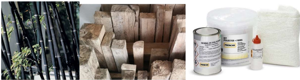
Figura 2 Material considerados para la construcción del generador eólico. Madera de bambú, madera de balsa y resina de fibra de vidrio (PRO & CAR, 2018) (Ya-Gu, 2022)
