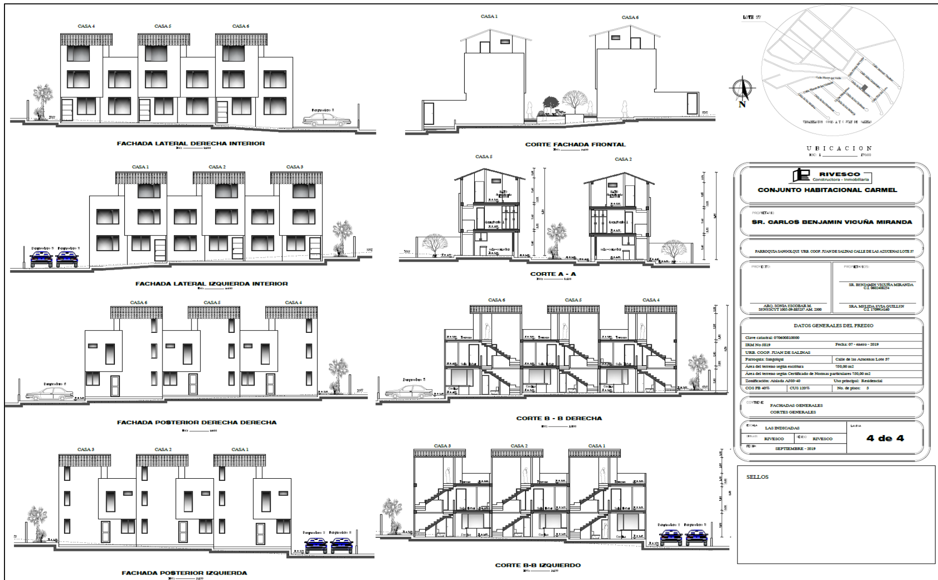
Ilustración 4:12: Planos Arquitectónicos - Fachadas Generales
