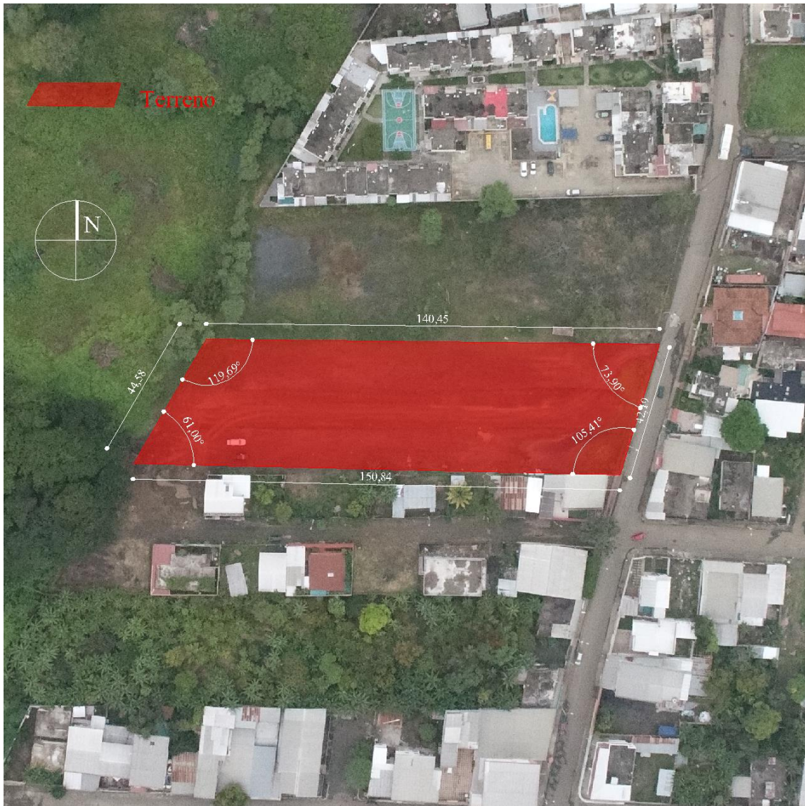
Ilustración 143: Dimensionamiento del terreno del proyecto. Fuente: Imagen captura con dron por el autor del caso.
