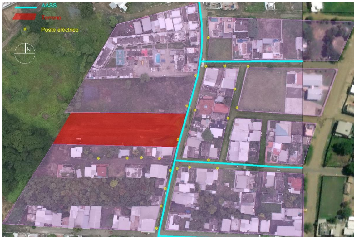
Ilustración 148: Esquema descriptivo de los servicios del terreno del proyecto. Fuente: Imagen captura con dron por el autor del caso.
