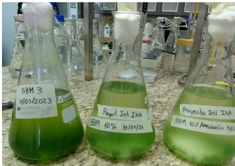
Figura 15. BBM3 e inóculos para el biorreactor
