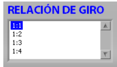
Figura 5.5 Cuadro de selección de la relación el giro del volante y giro de las ruedas
